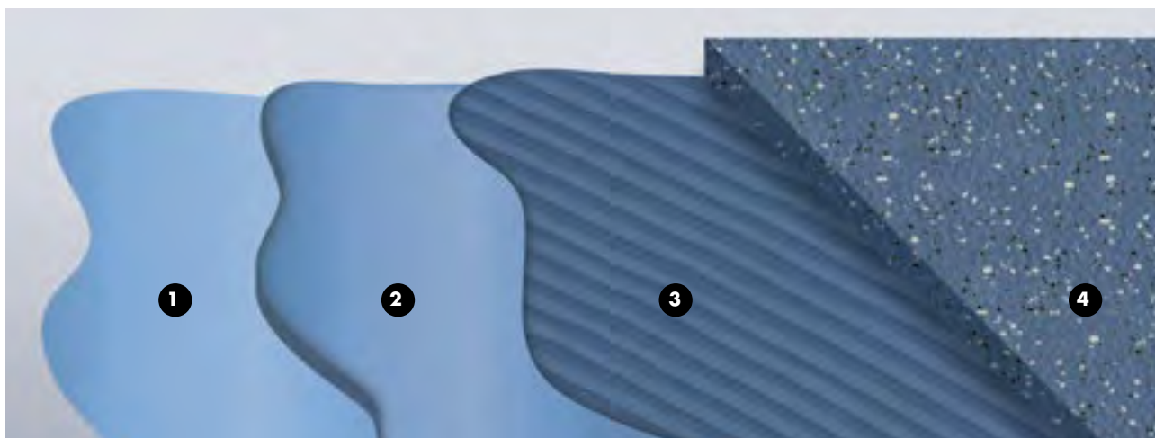
1 preparat do gruntowania 2 masa szpachlująca 3 klej 4 wykładzina podłogowa
